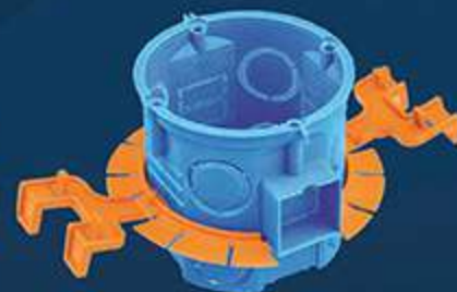
Obcinając diagonalnie łapki wybieramy głębokość osadzenia puszek
