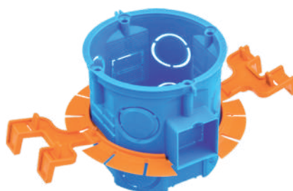
Obcinając diagonalnie łapki, wybieramy głębokość osadzenia puszek
